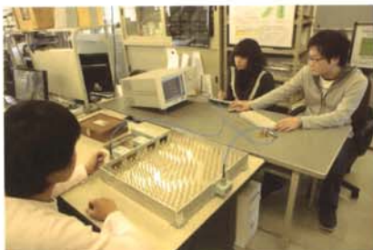
把输入信号等分为四的光子晶体波导管的研究所工作。
