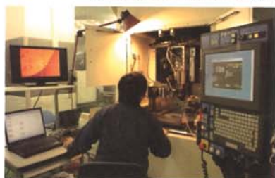
使用激光机器制作0.2毫米的金刚石车刀
