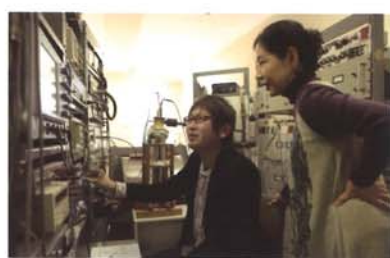
运用核磁共振(NMR)观察回波信号
