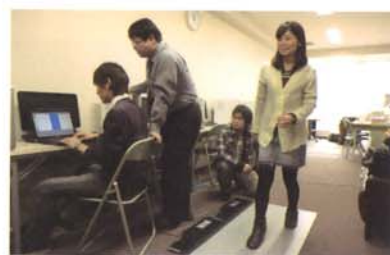
使用压力传感器辨别行人性别和年龄的实验
